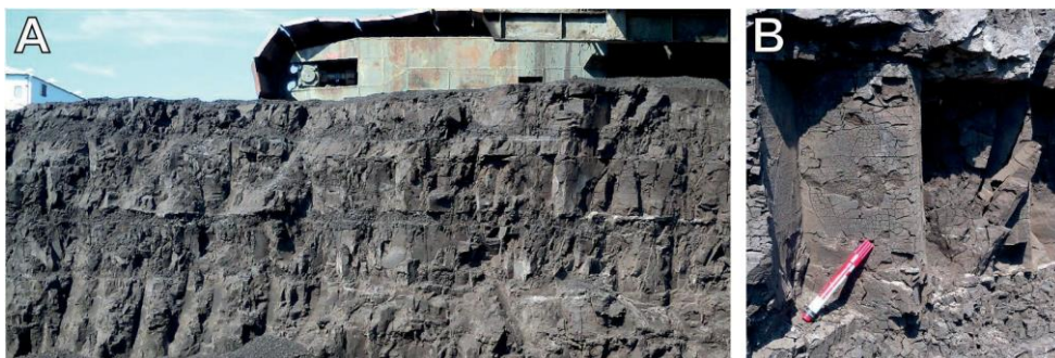
Ryc. 4. Spękania w węglu brunatnym z odkrywki Józwin IIB; zwróć uwagę na prawie prostopadle ułożenie spękań względem siebie i w stosunku do warstwowania (fot. M. Widera)
