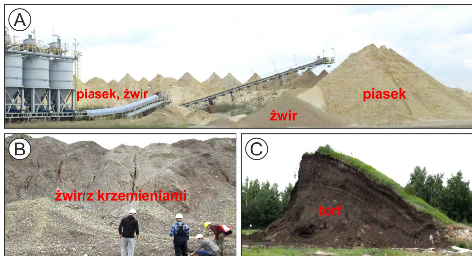
Ryc. 55. Zwały kopalin towarzyszących w Zakładzie Produkcji Kruszyw w Chabielicach, odkrywka Szczerców (KWB Bełchatów, 2018 rok, fot. M. Widera)
